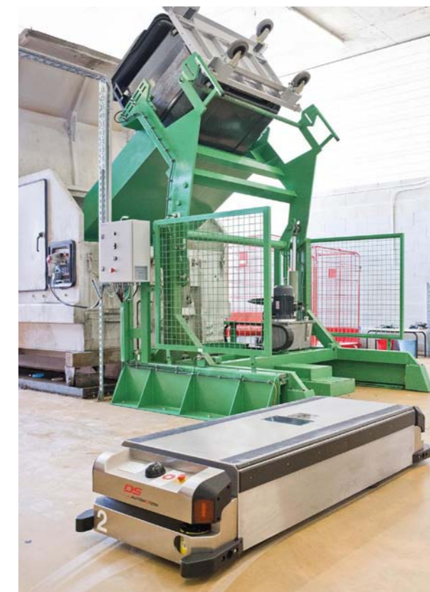
Uno de los tres vehículos autoguiados (AGV) que Clece gestiona en el Hospital Puerta de Hierro de Majadahonda (Madrid) para transportar las jaulas metálicas y contendedores.
